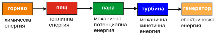
Фигура 1.0. Схема за превръщане на енергията от един вид в друг при производство на електрическа енергия в ТЕЦ
